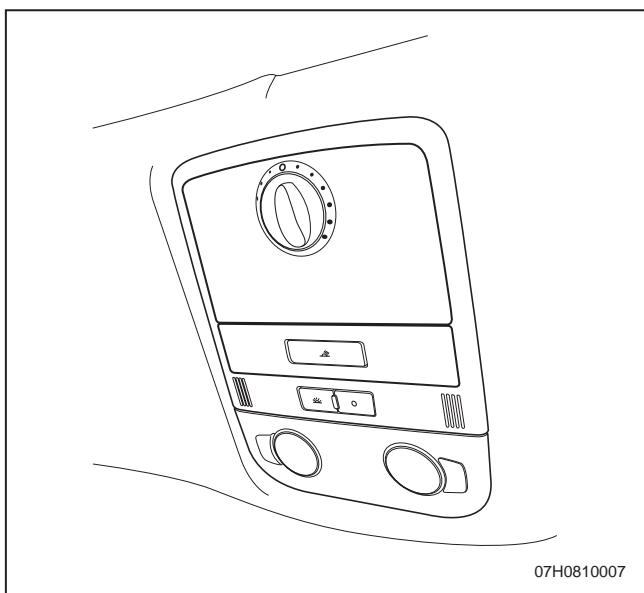
2. 断开电气连接器，取下前顶篷控制台。
