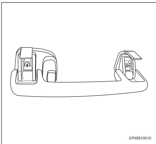
2. 拆卸固定螺钉，取下辅助拉手。
