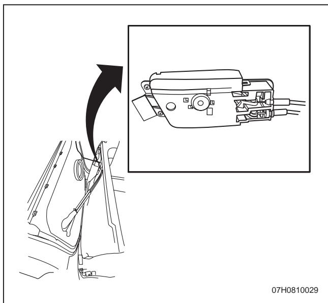
3. 断开电气连接器和内把手拉索，取下后侧门饰板。
