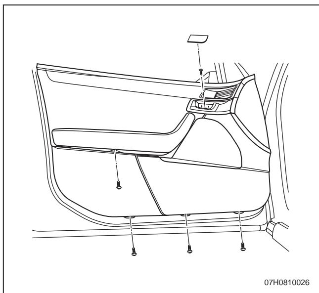
3. 断开电气连接器和内把手拉索，取下前侧门饰板。
