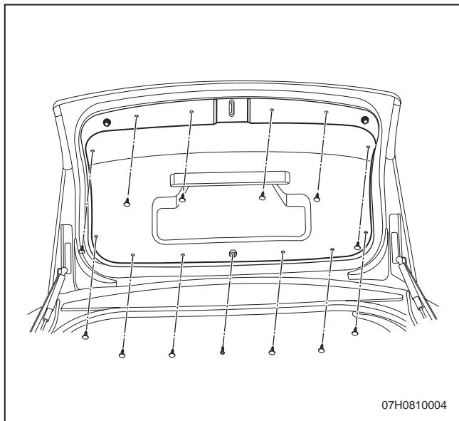
3. 安装路边停车标示牌卡夹固定螺钉和标示牌。
