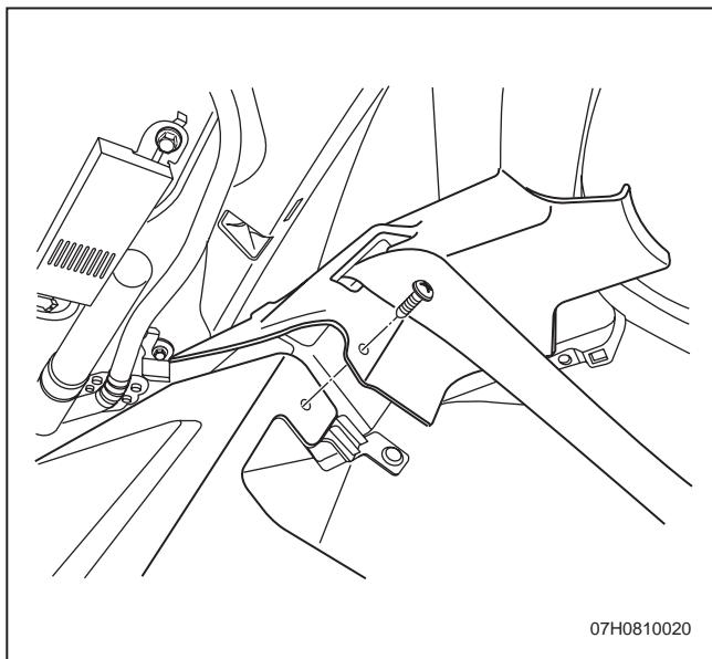
4. 安装后安全带导向板。
