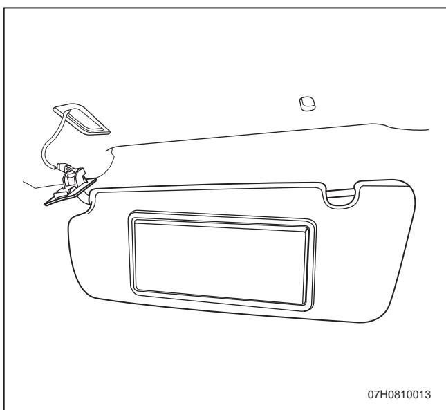
4. 断开电气连接器，拆卸遮阳板总成。
