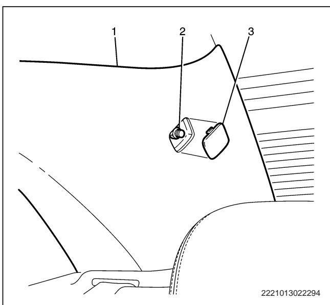
2. 安装后窗柱饰板和后窗柱饰板固定螺钉。
