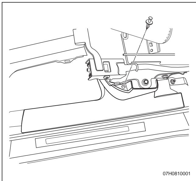
1. 拆卸后排座椅垫。参见 "8.15.5.21 座椅垫的更换 - 后座椅 (休闲座椅) " 和 "8.15.5.37 座椅垫的更换 - 后座椅 (整体式) "。
