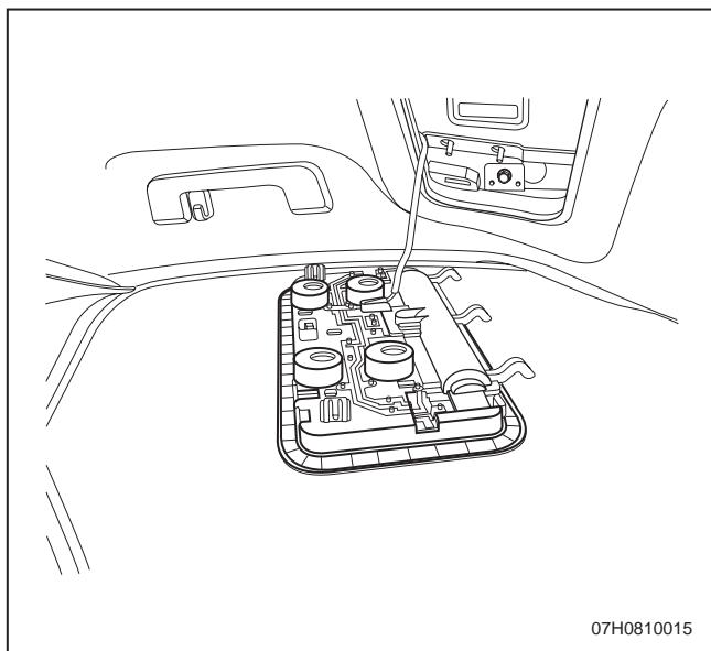
2. 安装化妆镜至车顶的紧固螺母。
